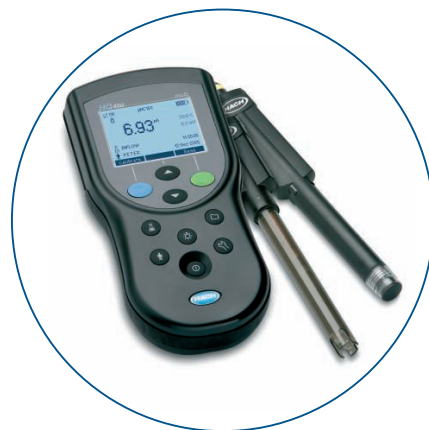
Slika 10: LDO senzor je na voljo tudi kot prenosni model za zunanjo uporabo in uporabo v laboratoriju.
